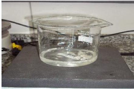
Figura 5: Solução contendo o polímero carboximetilcelulose e água sob agitação constante (a), Solução contendo o polímero hidratado (b).
