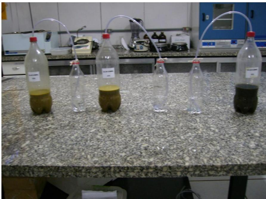
Figura 15 - Mini-Biodigestores caseiros
