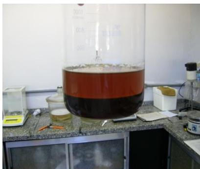
**Figura 12 – Diferenças de Fases do Biodiesel e Glicerol.**
