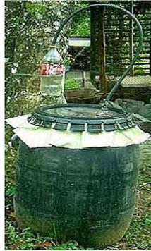
**Figura 06 - Biodigestor Modelo Batelada (CURUPIRA, 2009).**
