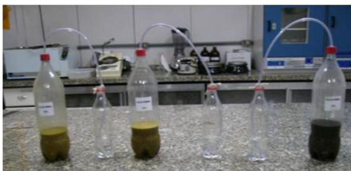
**Figura 17 – Biodigestores, com garrafas PET para liberação do gás metano**
