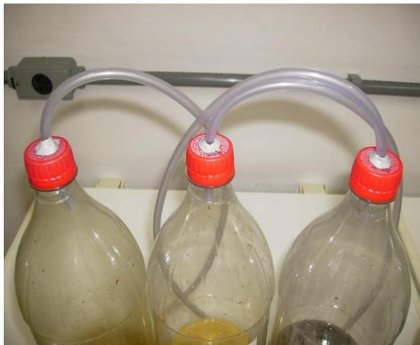
**Figura 16 – Biodigestores, com vedante nas tampas**
