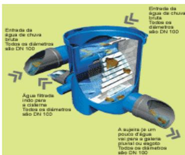
O primeiro passo do tratamento da água de chuva se dá através do filtro. A água corre do telhado para o filtro, onde a água é separada das impurezas (carga orgânica). A água limpa é encaminhada para a cisterna, enquanto a sujeira, impulsionada por um pequeno volume d'água, vai para a galeria pluvial, ou melhor, ainda, para o sistema anexo de infiltração no subsolo, que permite a recarga das águas subterrâneas e o recolhimento das impurezas para compostagem.
