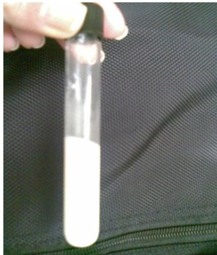
**Figura 7:** mistura resultante da decomposição do PET, inicialmente líquida e homogênea, solidifica após alguns minutos.
