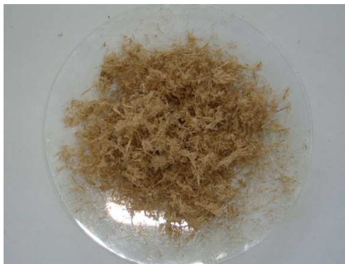
Figura 12 - Bagaço após explosão com hidróxido de sódio 4%
