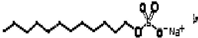
**Figura 5** - Estrutura do Dodecil Sulfato de Sódio<sup>16</sup>
