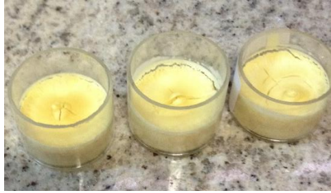
Figura 4: Membranas após liofilização.
